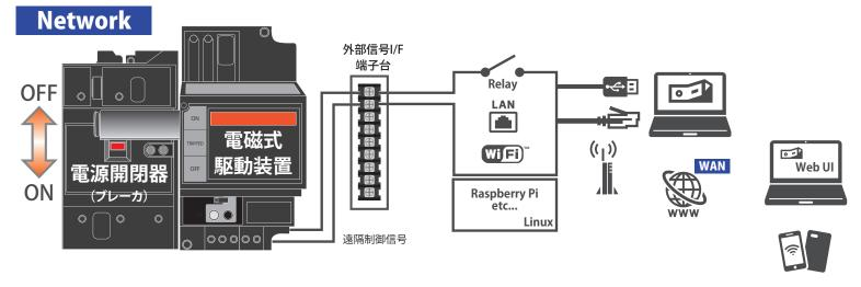
アナログ信号をデジタル信号に変換するリレー基盤(市販品可)を用います。 インターフェイス搭載したもの、無線機能やルーター機能を有するものなど用途に応じお選びいただけます。 PC、携帯端末などから制御を行う場合、シングルボードコンピューター(Raspberry Pi)を用いることで、 制御 UI(アプリケーション)のカスタマイズ、ネットワーク設定が容易に行えます。
