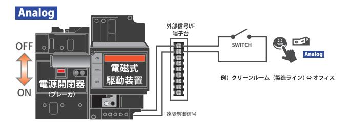
外部端子と操作デバイスを結線し、接点信号を用いる最もシンプルな方法です。 同一建屋内などで開閉を遠方から行いたい場合に使用します。 ★操作デバイスは、スイッチ、リモコンなど形状は問いません。
